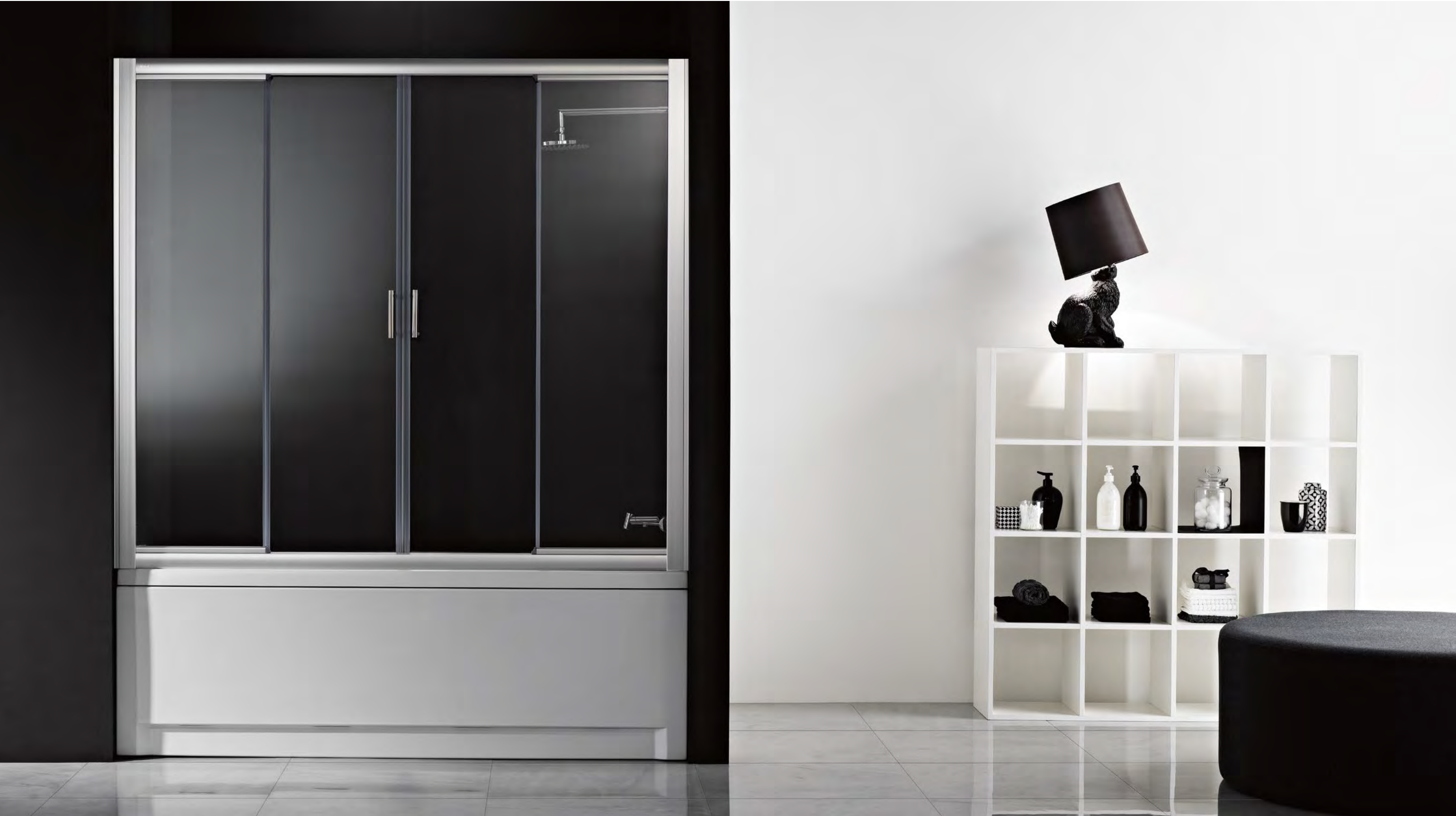
PT - Dois painéis fixos e duas portas de correr. Rolamentos esferas inox. Vidro temperado de 6mm. Perfis em alumínio lacado branco, metalizado or cromado. Altura standard: 1500mm. EN - Two fixed panels and two sliding doors. Inox ball-bearins rollers. 6mm tempered glass. Aluminium profiles lacquered white, methalized or chromed. Standard height: 1500mm. FR - Deux panneaux fixe et deux portes coulissantes. Roulements à billes en acier inoxydable. Verre trempé de 6mm. Profils en aluminium laqué blanc, métalliques ou en chrome. Hauteur standard: 1500mm. ES - Dos paneles fijos y dos puertas corredoras. Rodamientos de bolas de acero inoxidable. Vidrio templado de 6mm. Perfiles de aluminio lacado blanco, metálico o de cromo. Altura estándar: 1500mm.
