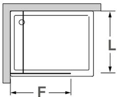
O cliente deve fornecer a dimensão "L", resultante da medição da parede até à face exterior da base.
