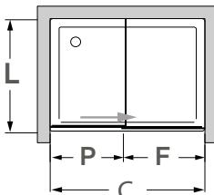
O cliente deve fornecer a dimensão "L", resultante da medição da parede até à face exterior da base.
