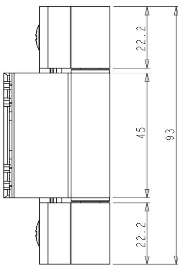
■ Dobradiça em alumínio para perfis em alumínio de canal europeu. Recomendada para uso em forças transversais. Desenvolvida para suportar cargas elevadas. Fiel em inox 304.
